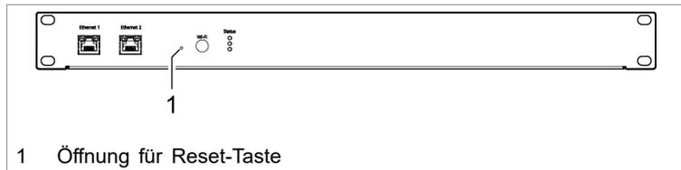
Reset-Taste an der Systemsteuerung Fig. 41
