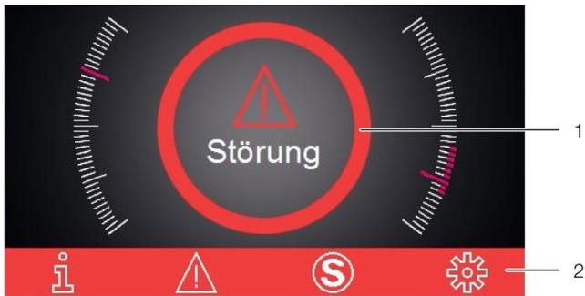
Abb. 22: Bildschirm bei Auftreten einer Störung
