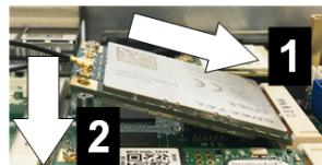
Rys. 5-10: Wkładanie płytki
