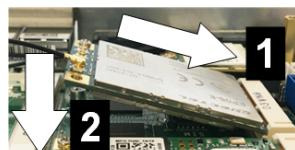
Fig. 5-10: Montaje de la placa
