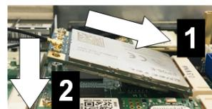
Kuva 5-10: Piirilevyn asettaminen
