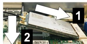
Şek. 5-10: Platinin yerleştirilmesi
