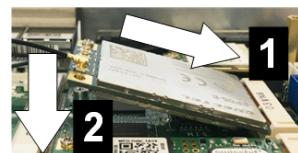
Fig. 5-10: Insertion de la platine
