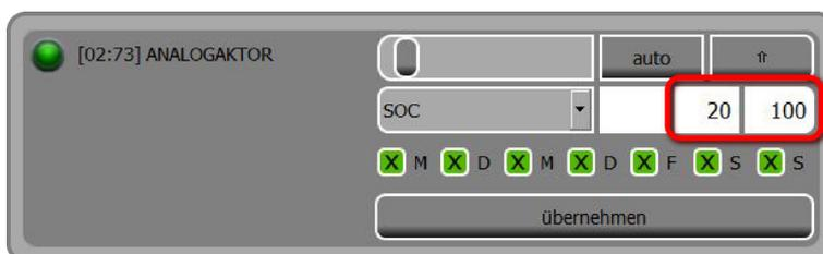
Abb. 157: Beispiel für Analogaktor Batterieladung (SOC)
