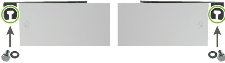
Abb. 19: Kippschutzbügel an der Montagewand befestigen
