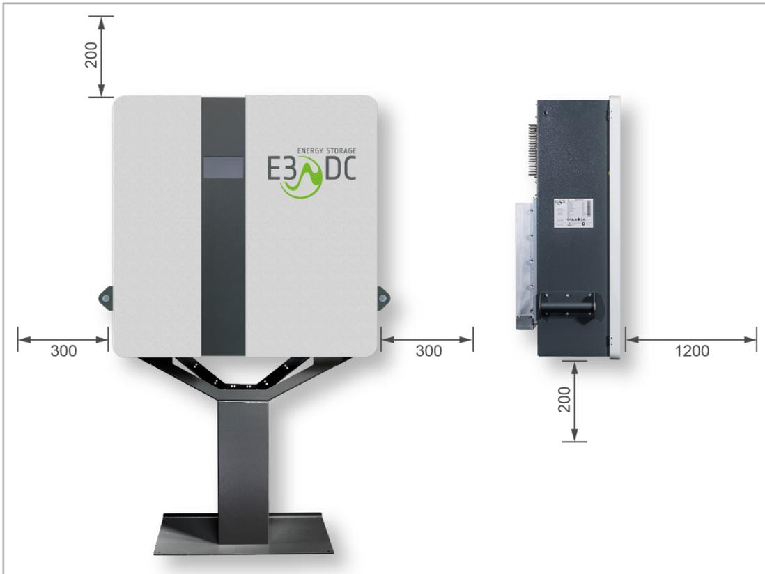
Abb. 7: Mindestabstände zu den Raumwänden | zur Raumdecke | zum Boden | nach vorn (in mm)
