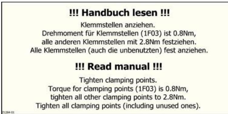
Abb. 55: Drehmomente überprüfen – Aufkleber im Verteilerkasten des Geräts
